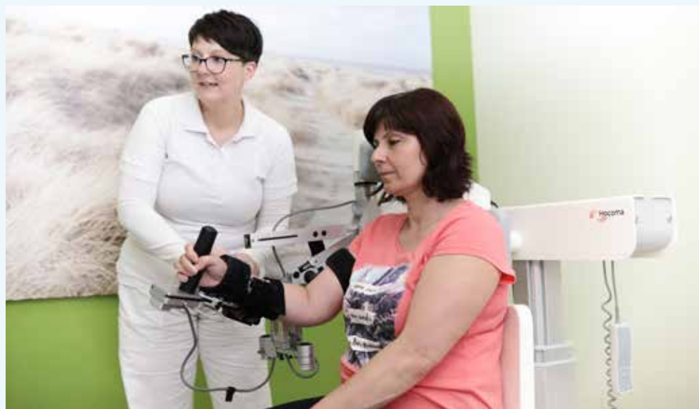
K rehabilitaci pacientů, kteří mají po mrtvici sniženou funkci horní končetiny, Sanatoria Klimkovice využívají také robotickou ruku Armeo. Terapie s přístrojem je spojena s vizuální zpětnou vazbou. Pohyby horní končetiny snímají senzory. Princí zpětné vazby podporuje obnovu nejen pohybových, ale i komunikačních a kognitivních funkcí. Foto: Sanatoria Klimkovice
