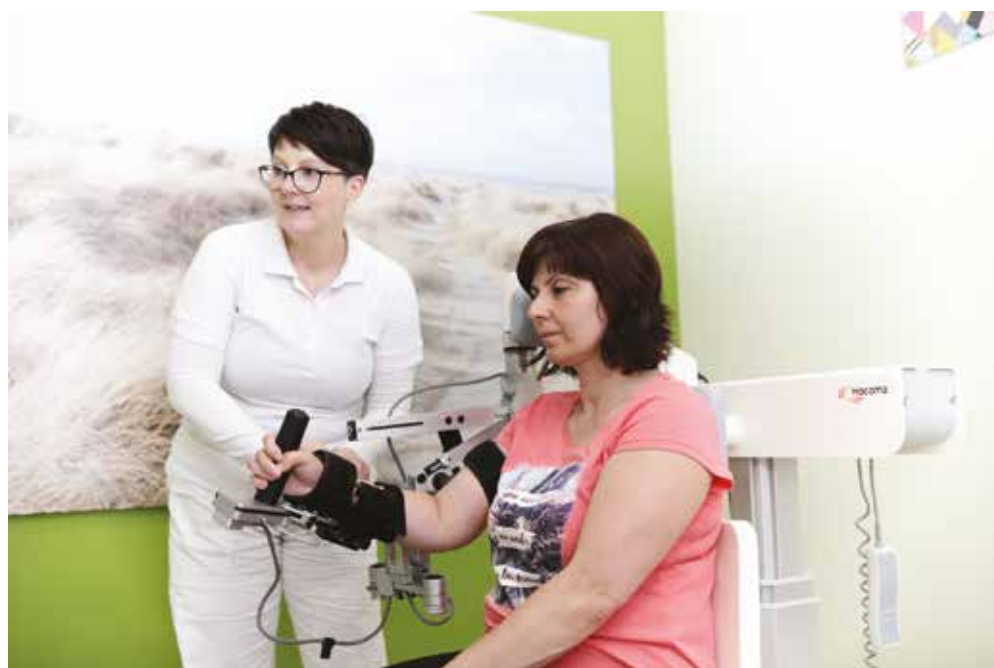
K rehabilitaci pacientů, kteří mají po mrtvici sniženou funkci horní končetiny, Sanatoria Klimkovice využívají také robotickou ruku Armeo. Terapie s přístrojem je spojena s vizuální zpětnou vazbou. Pohyby horní končetiny snímají senzory. Pacient robotickou rukou ovládá herní prostředí a plní úkoly, jejichž náročnost se přizpůsobuje jeho stavu. Princip zpětné vazby podporuje obnovu nejen pohybových, ale i komunikačních a kognitivních funkcí. Foto: Sanatoria Klimkovice
